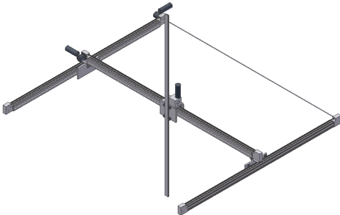
Obrázek 5.4: Model pojezdu TTT v Autodesk Inventor 2010
