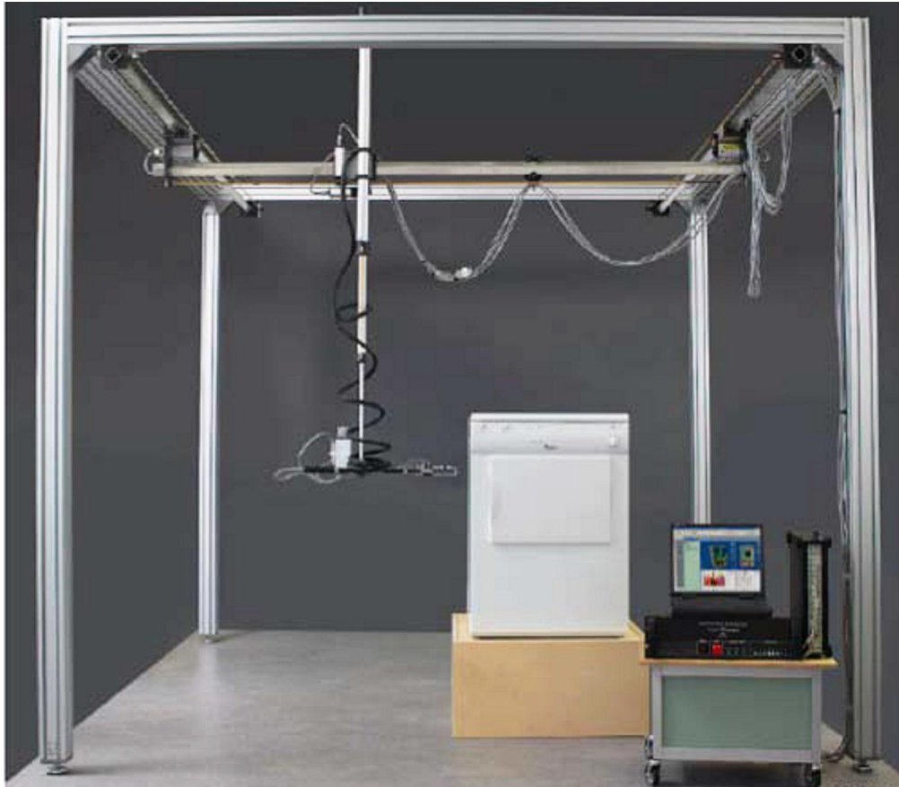
Obrázek 4.1: Polohovací zařízení pro měření intenzity zvuku od firmy Brüel & Kjaer [9]
