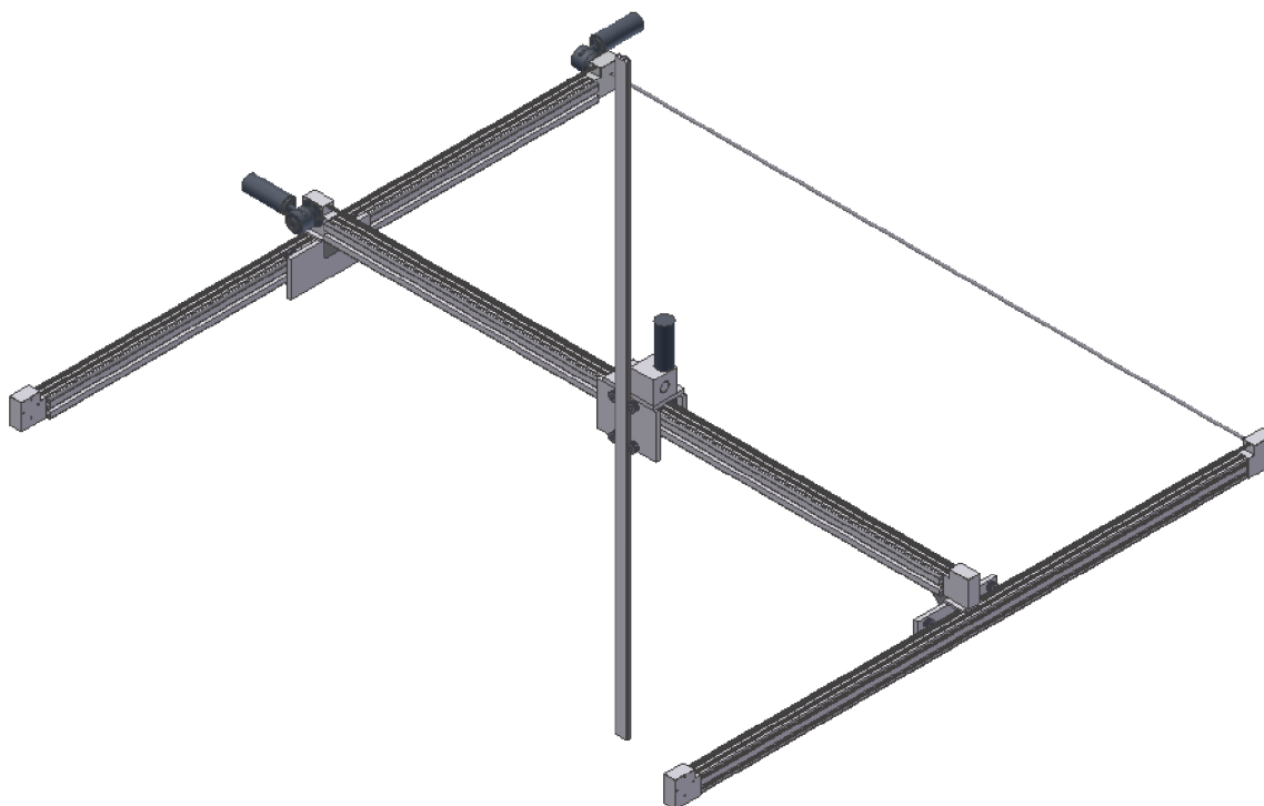
Obrázek 5.4: Model pojezdu TTT v Autodesk Inventor 2010
