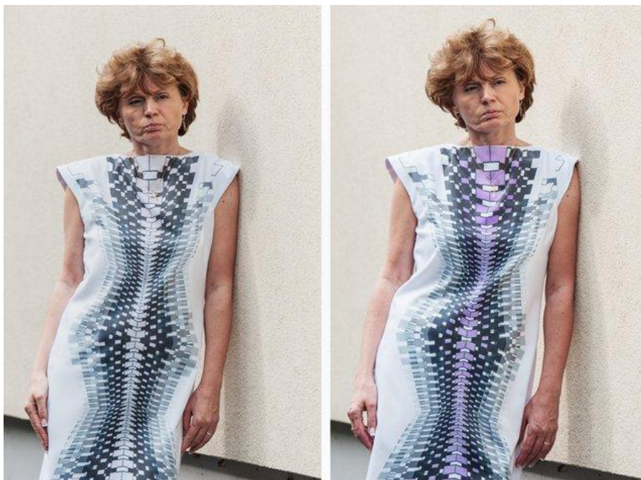
Obr. 3 Členka týmu Ing. Martina Viková předvádí šaty reagující změnou barevnosti na dopadající UV záření [16]
