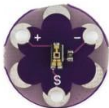
Obr. 22 Světelný senzor LilyPad [35]
