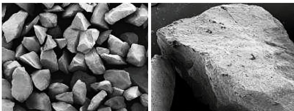
Obr. 16 Struktura povrchu ostřiva Molochit [27].
