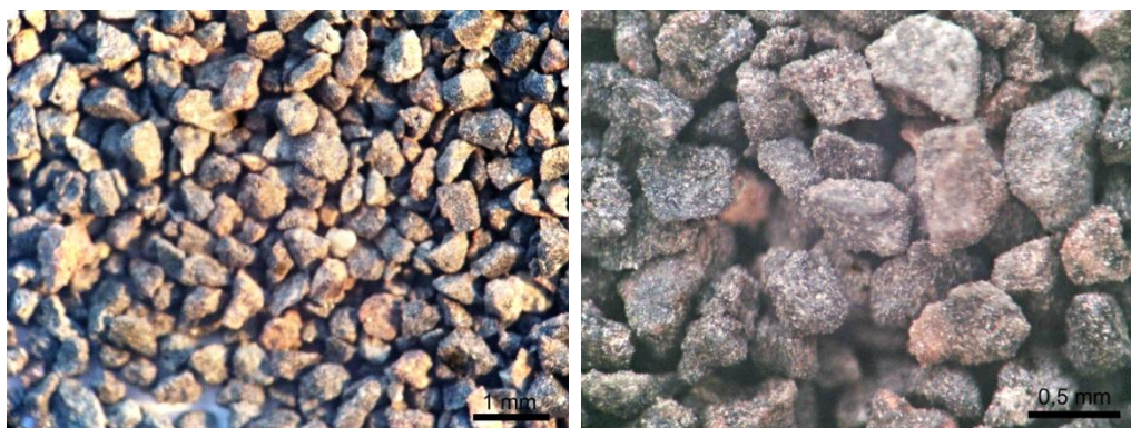
Obr. 21 Struktura povrchu dunitového ostřiva [22].
