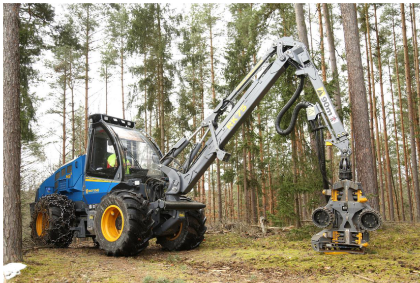
Obrázek 8: Kolový harvester ROTTNE H8E – ideální pro těžbu z místa v probírkovém porostu zdroj (Reparoservis ©2024).
