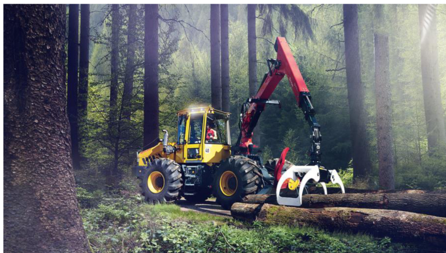
Obrázek 6: Speciální lesní kolový traktor Welte W130 (Reparoservis, ©2024).
