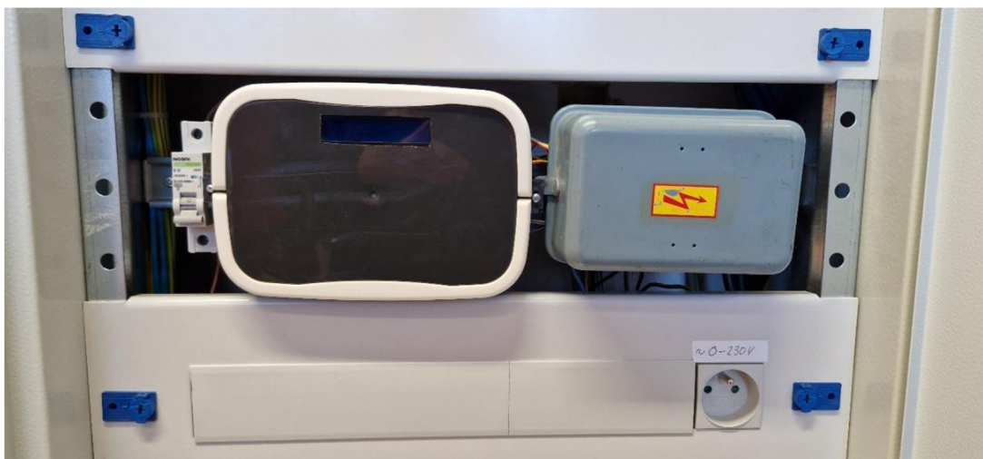
Obrázek 66: Prototyp inovativního wattrouteru [zdroj: autor]
