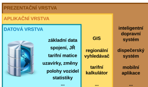
Obr. 5 Třívrstvá architektura navrženého informačního systému pro správu a práci s geodaty (vlastní zpracování)
