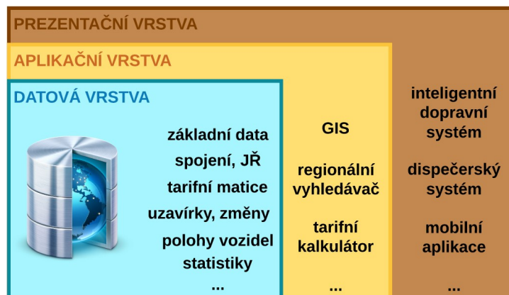
Obr. 23 Třívrstvá architektura navrženého informačního systému pro správu a práci s geodaty (vlastní zpracování)
