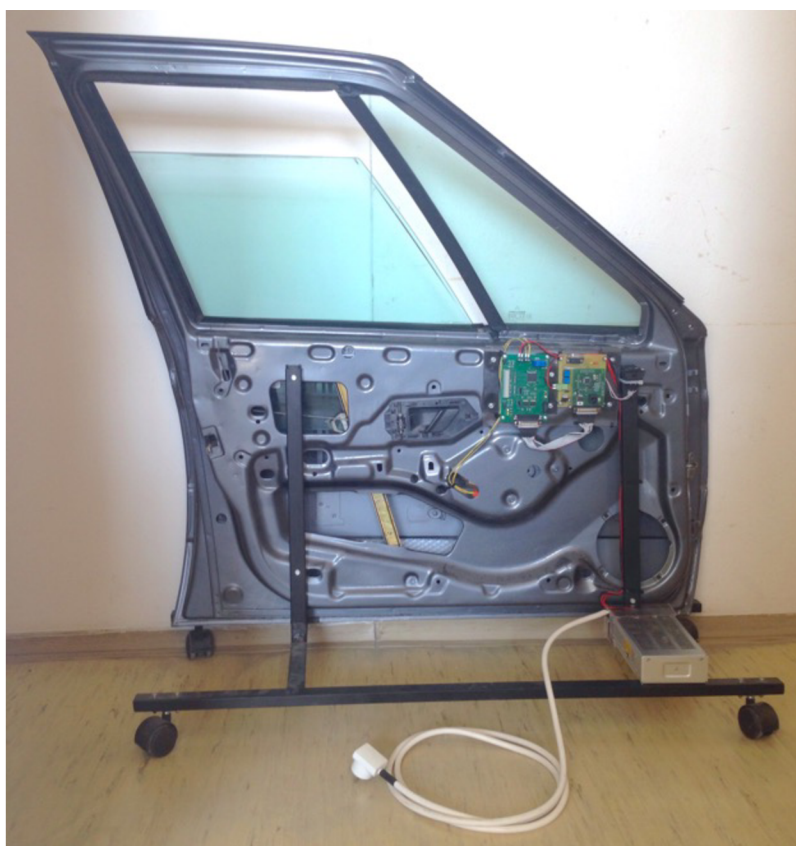
Obr. 13 Model okna s nainštalovanou elektronikou
