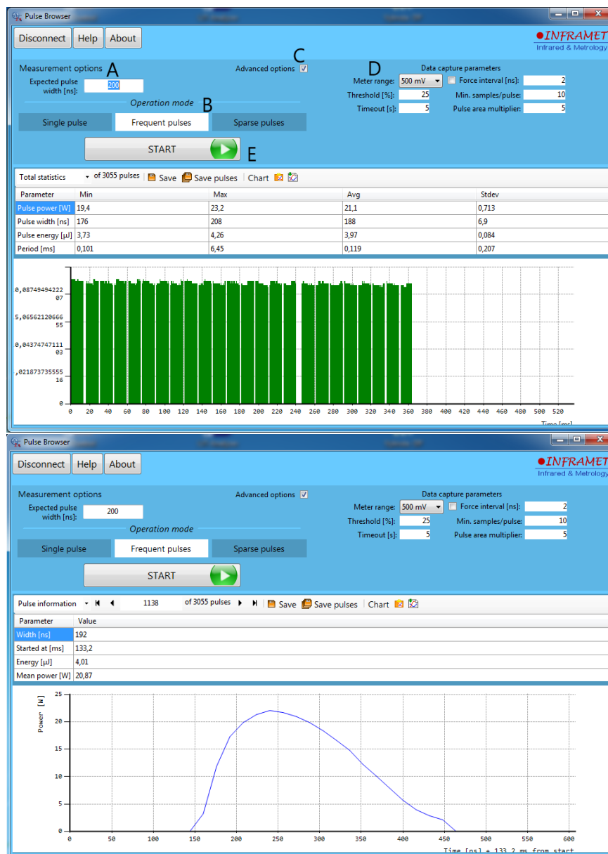
Obrázek 2.5: Okno programu Pulse Browser s nastavením pro měření PLRF25C BLE X3 při zobrazení všech pulzů a s výběrem jednoho pulzu.
