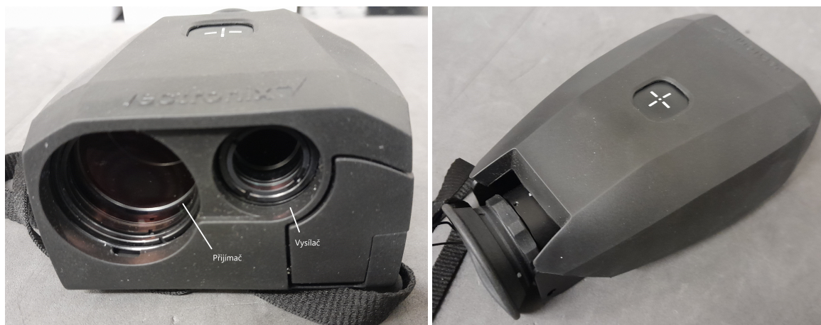
Obrázek 1.4: PLRF25C BLE X3 v předním a zadním pohledu s označením vysílače a přijímače laserového dálkoměru.
