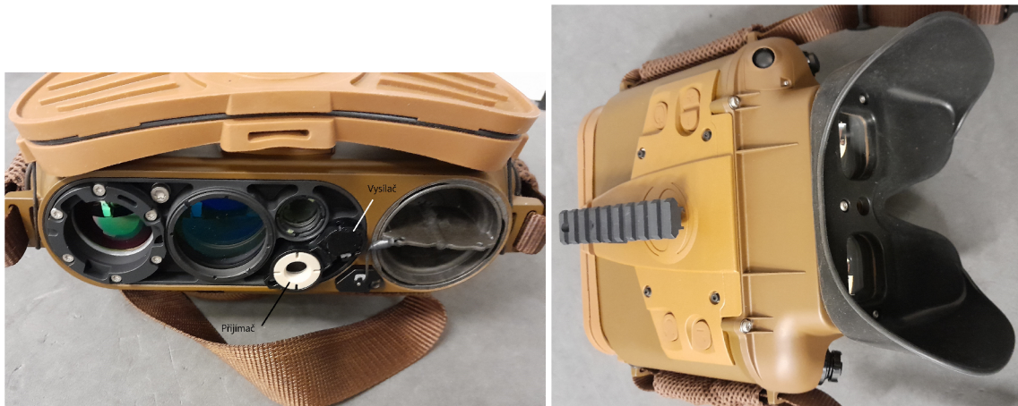
Obrázek 1.6: JIM Compact v předním a zadním pohledu s označením vysílače a přijímače laserového dálkoměru.
