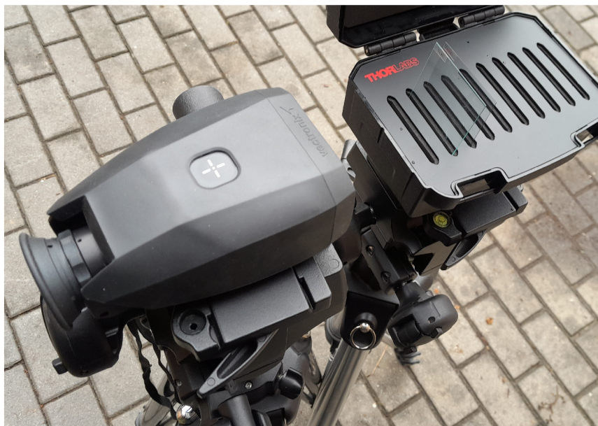
Obrázek 3.6: Sestava pro měření extinkčního poměru a dosahu v exteriéru.
