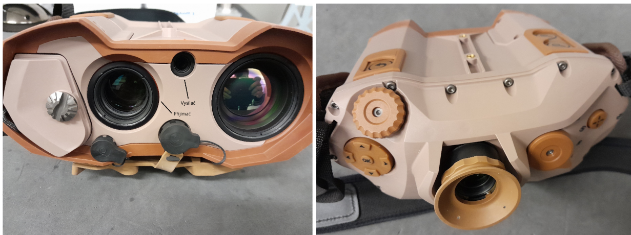
Obrázek 1.5: Moskito TI+ v předním a zadním pohledu s označeným vysílačem a přijímačem laserového dálkoměru.
