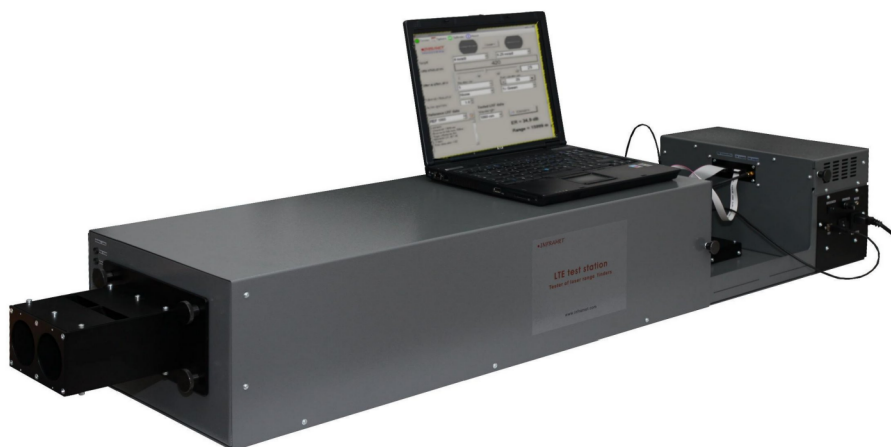
Obrázek 2.1: LTE měřicí stanice. [16]
