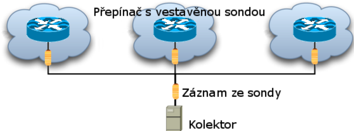
Obrázek 2.1: Blokové schéma monitorovacího systému
