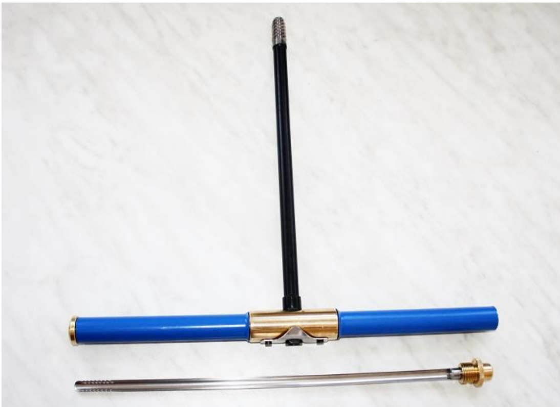
Obrázek 11: Přírůstkový vrták o průměru 10 mm.
