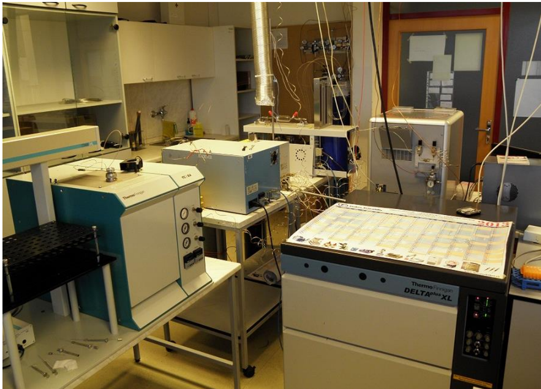
Obrázek 12: Izotopový poměrový hmotnostní spektrometr (Thermo Finnigan DELTA plus XL) s příslušenstvím. Foto: Necudová L. (2013).
