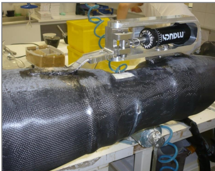
Obr. 4-36 Přilepené dlahy hydraulického kolenního kloubu
