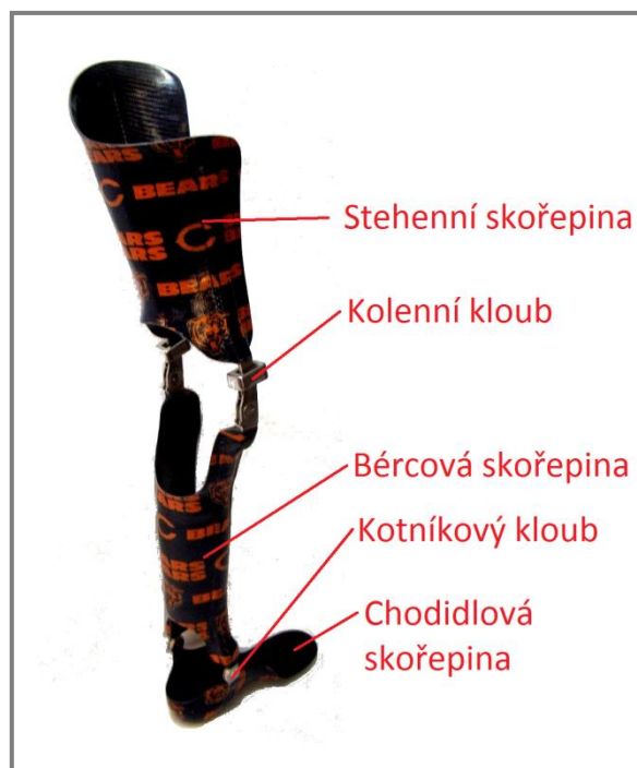
Obr. 1-9 Části koleno - kotníkové ortézy [4]
