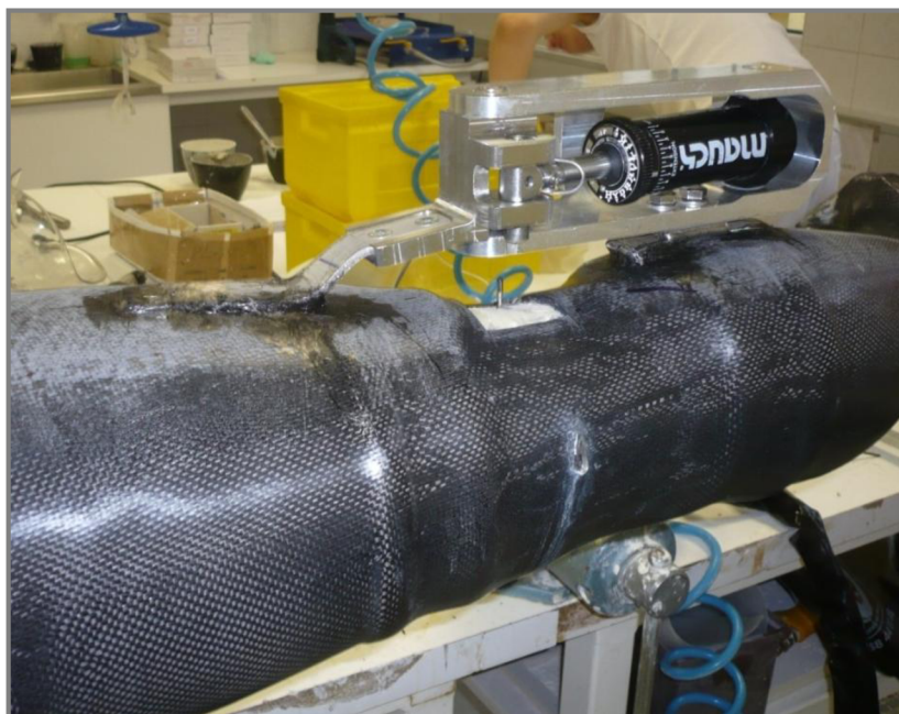
Obr. 4-36 Přilepené dlahy hydraulického kolenního kloubu
