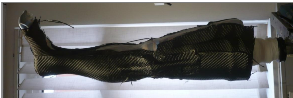
Obr. 4-35 Nanášení uhlíkových tkanin
