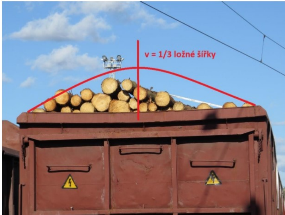
Obr. 1.10 Nesprávne naložený vagón
