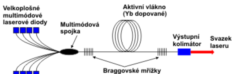
Obrázek 3.3 – Schéma vláknového laseru [31]
