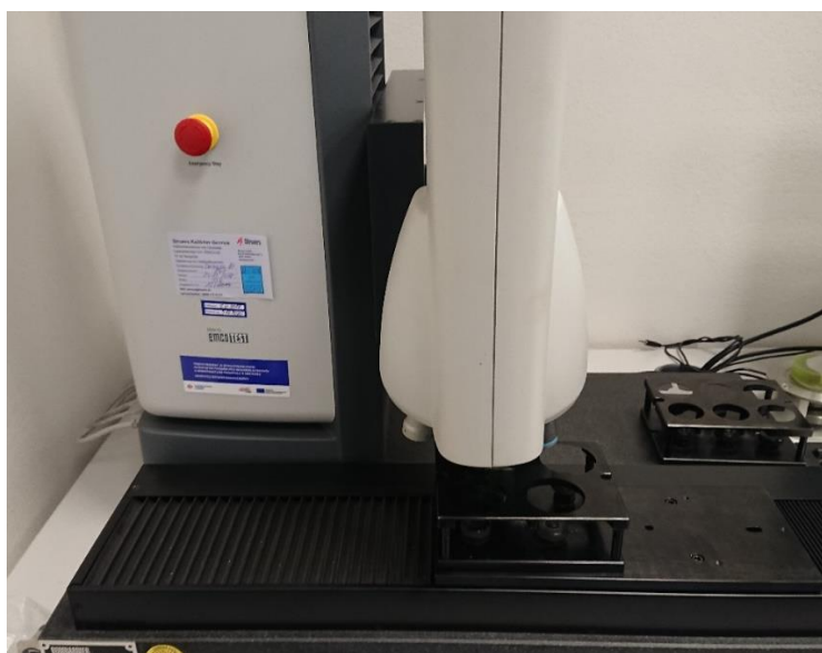
Obrázek 4.8 – Tvrdoměr Struers Durascan-80
