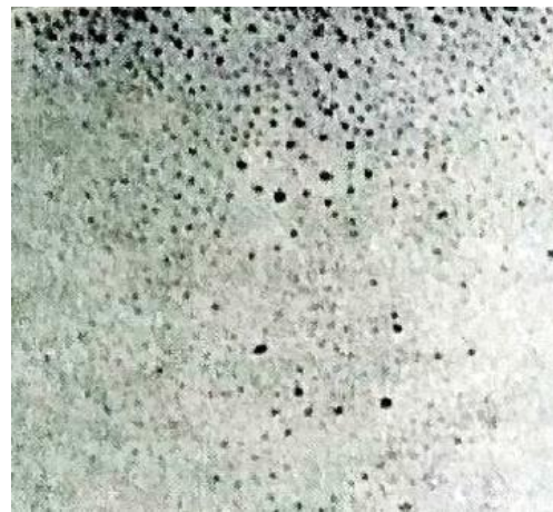
Obr. č. 11 – Vada smaltového povlaku – Póry
