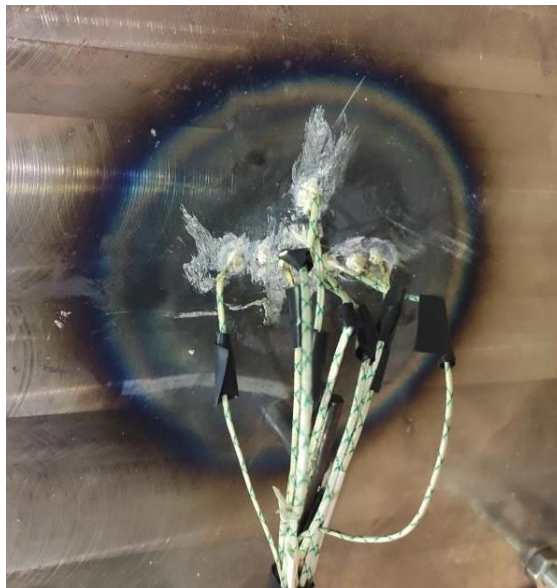
Obr. č. 46 – Deska ze základního materiálu osazena termočlánky typu K
