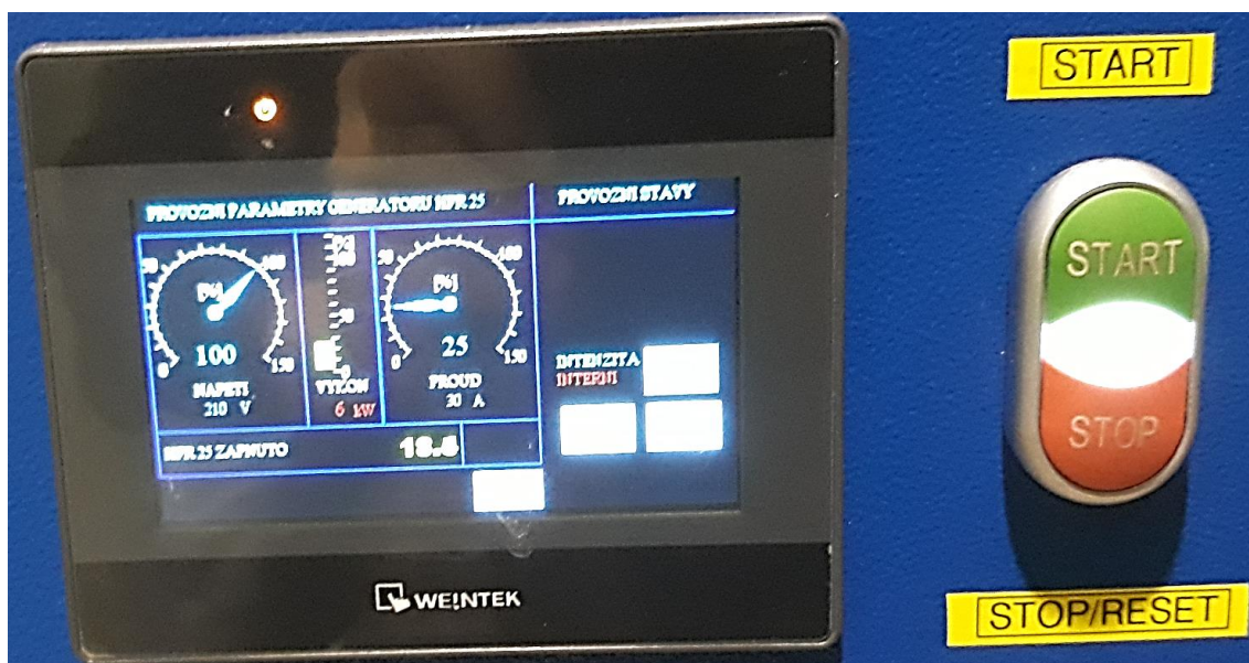
Obr. č. 48 – Displej usměrňovače induktoru – provozní parametry
