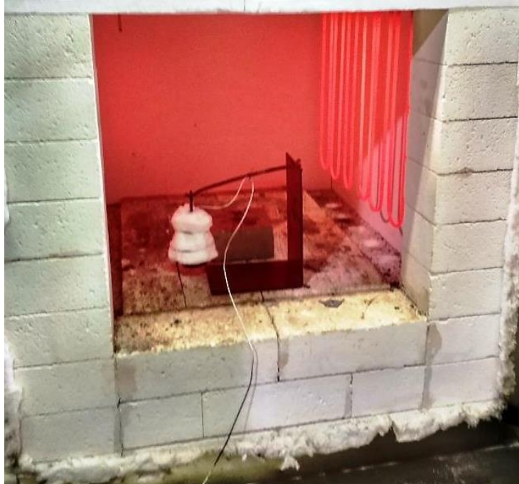
Obr. č. 26 – Odporová pec s umístěným vzorkem
