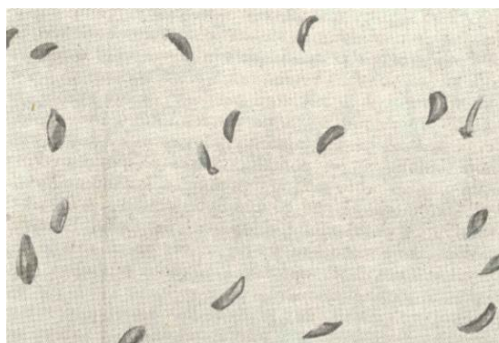
Obr. č. 13 – Vada smaltového povlaku – Rybí šupiny [5]
