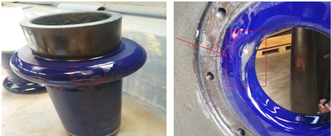
Obr. č. 12 – Vada smaltového povlaku – Odprýsknutí smaltu
