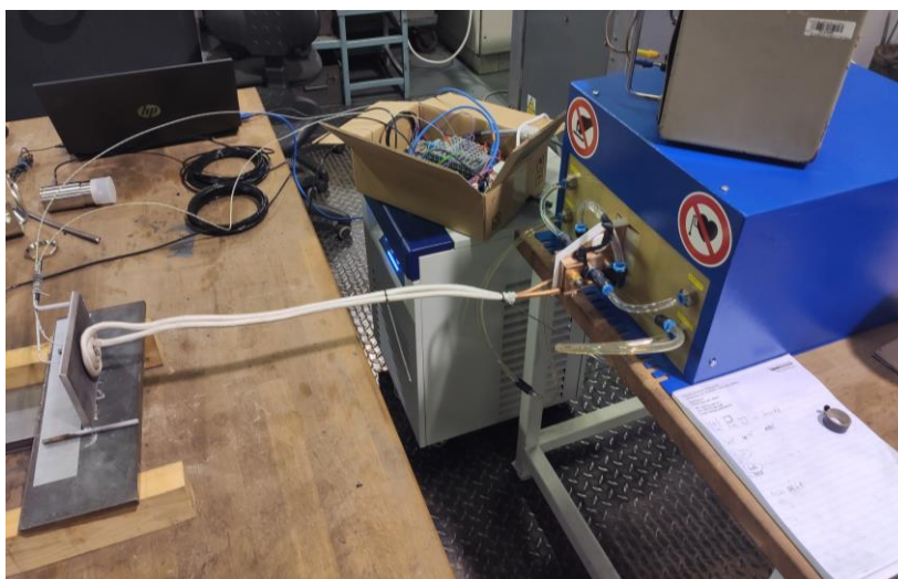
Obr. č. 33 – Generátor typ HFR s induktorem a měřeným vzorkem
