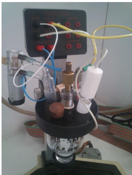
Obr. 9: Tříelektrodové zapojení voltametrické cely pro měření.
