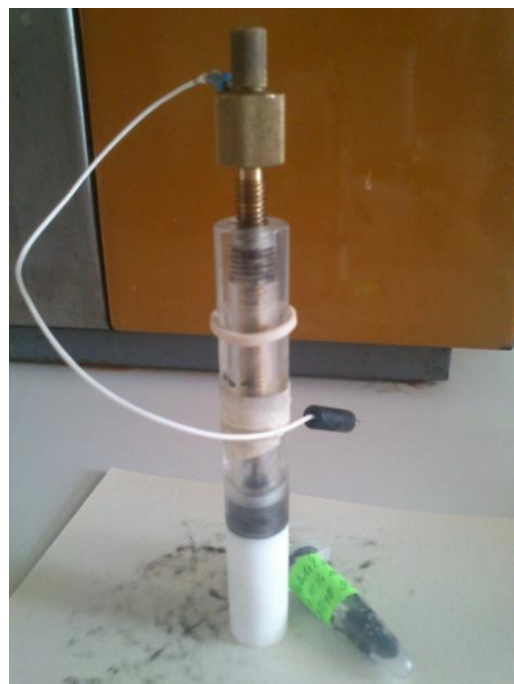
Obr. 10: Uhlíková pastová elektroda pro experimentální měření.
