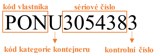
Obr. 1.6 BIC Code kontejneru
