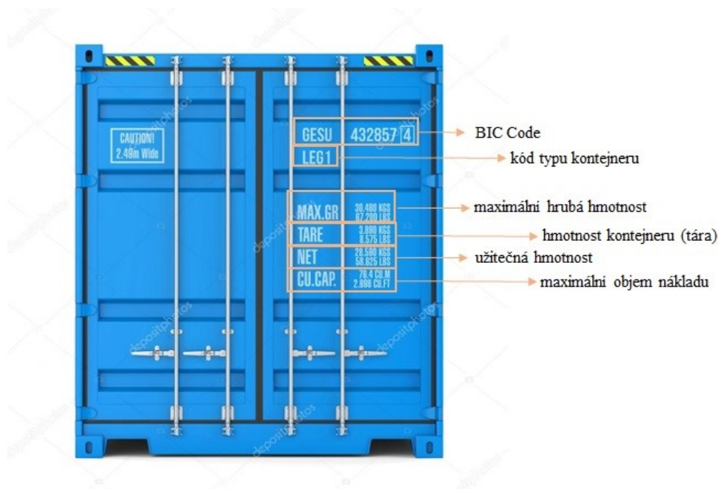
Obr. 1.7 Způsob identifikace a označování kontejnerů
