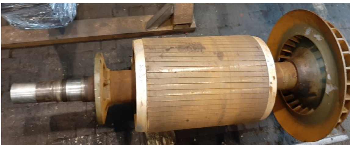
Obrázek č. 9: Koroze rotoru elektromotoru
