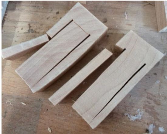
Obr. 12 Zkouška zbytkového napětí vidličkovou zkouškou - znehodnocený vzorek podél dřevěného paprsku.
