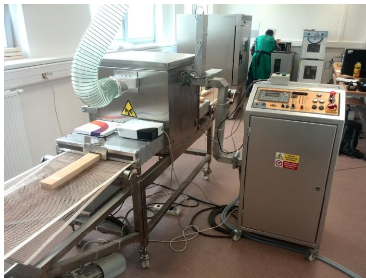
Obr. 16 Mikrovlnná linka v laboratořích Mendelovy univerzity v Útěchově u Brna. Na obrázku je vidět pásový dopravník se stíněním, komora, odtah přebytečných mikrovln a mikrovlnný generátor s řídicí jednotkou.
