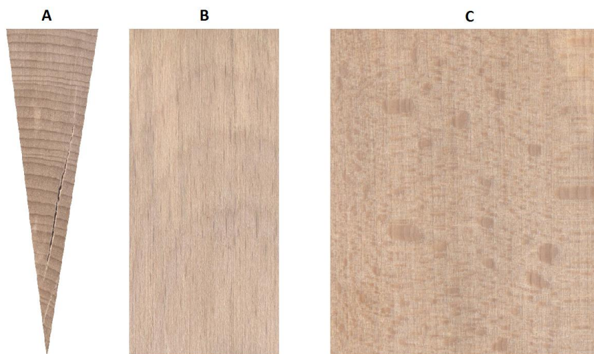
Obr. 1 Řezy bukem , A - příčný řez, B - tangenciální řez, C - radiální řez ( http://wood.mendelu.cz ).
