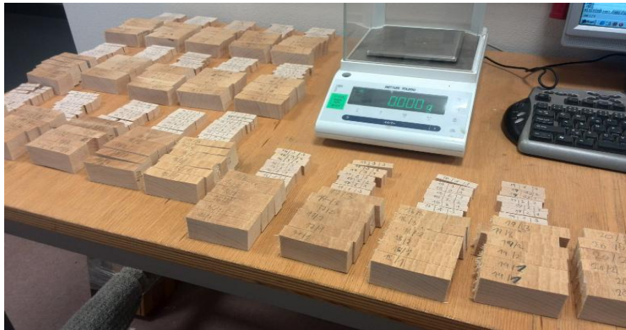
Obr. 13 Vzorečky na zkoušku vlhkostního spádu a zkoušky zkornatění.
