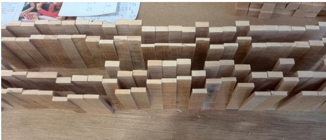
Obr. 14 Zkouška zkornatění - vzorky vidličkové zkoušky.
