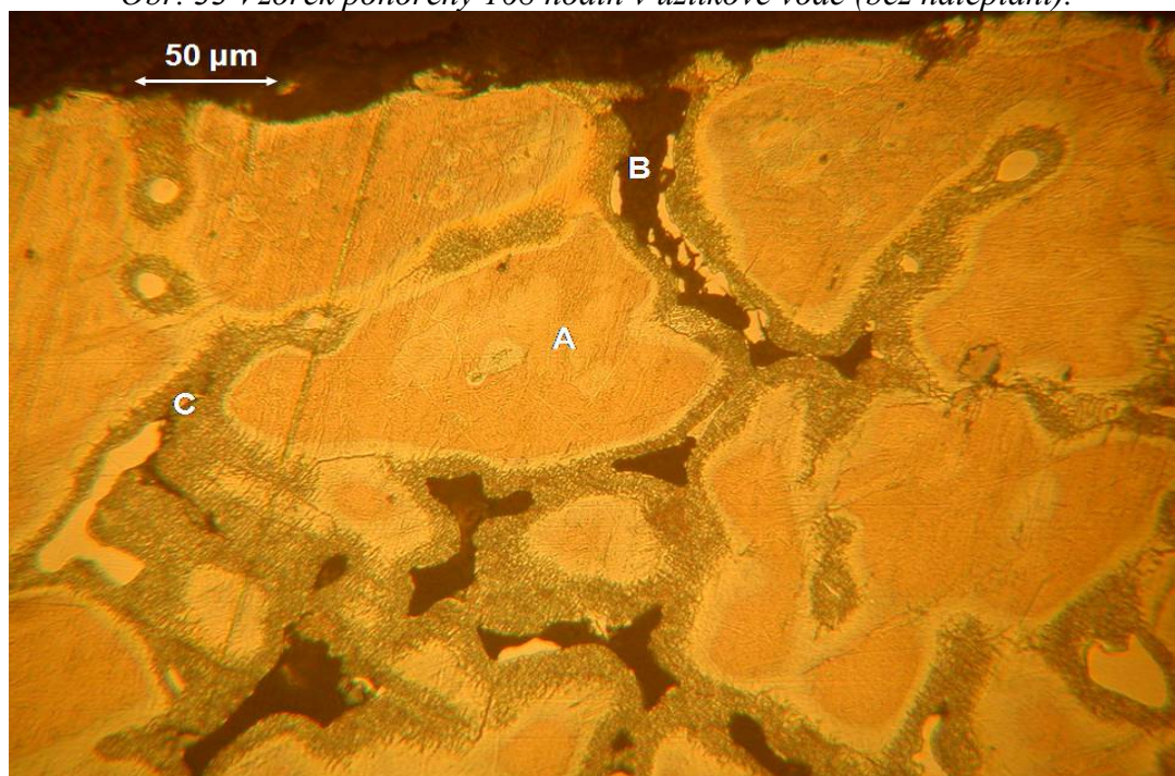
Obr. 34 Vzorok ponořený 168 hodin v užitkové vodě (leptáno roztokem kyseliny pikrové): A- primární zrno, B- zkorodovaná oblasť, C- eutektikum.
