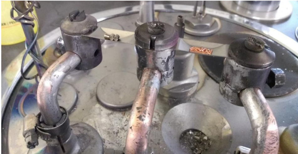
Obrázok 3.25 - Elektródy a držiaky po vyčistení
