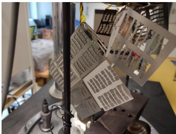
Obrázok 3.18 - Odtrhnutie šablón od substrátov
