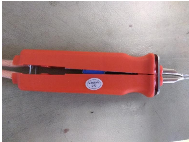
Obrázok 3.14 - Zvaracie pero po vložení PVC materiálu
