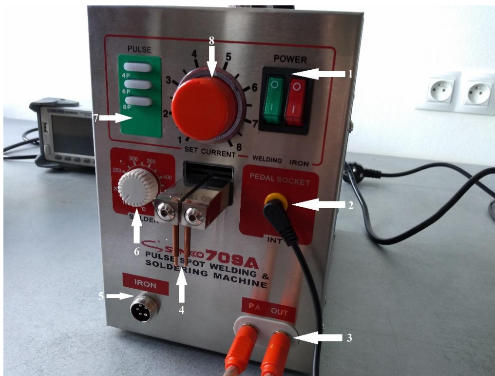
Obrázok 3.1 - Bodová zváračka Sunkko 709A: 1. Spínač pre spájkovanie a pre zváranie; 2. Konektor pre pripojenie pedálu; 3. Konektory pre pripojenie ručných elektród; 4. Elektródy umiestnené vo vnútri tela zváračky; 5. Konektor pre pripojenie spájkovačky; 6. Regulátor teploty spájkovačky; 7. Nastavenie počtu pulzov zvárania; 8. Regulátor zváracieho prúdu
