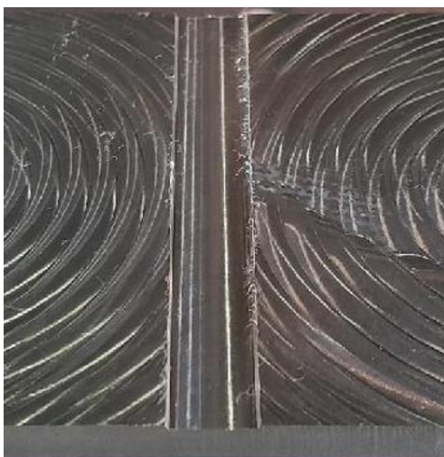
a) Drážka po průchodu neopotřebeného nástroje
