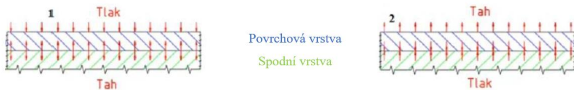
Obr. 11 Působení vnitřních napětí.
