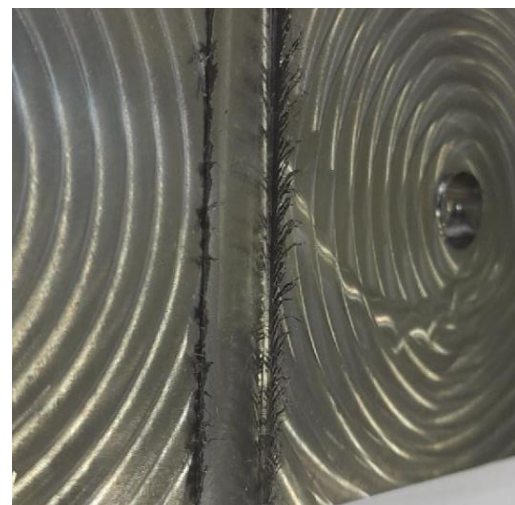
b) Drážka po průchodu opotřebeného nástroje
