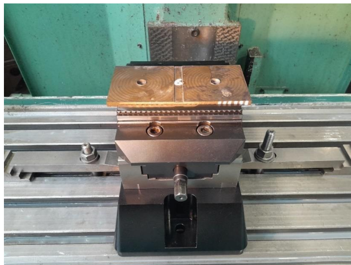
Obr. 57 Vzorek upnutý ve svěráku.
