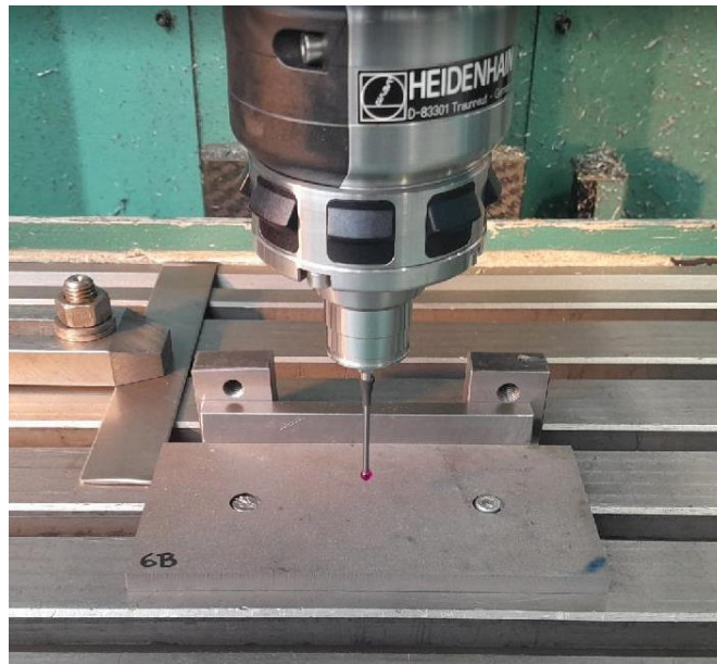
Obr. 49 Měření rovinnosti vzorku pomocí dotykové sondy v upnutém stavu.
