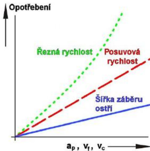
Obr. 7 Vliv řezných podmínek na opotřebení [1].
