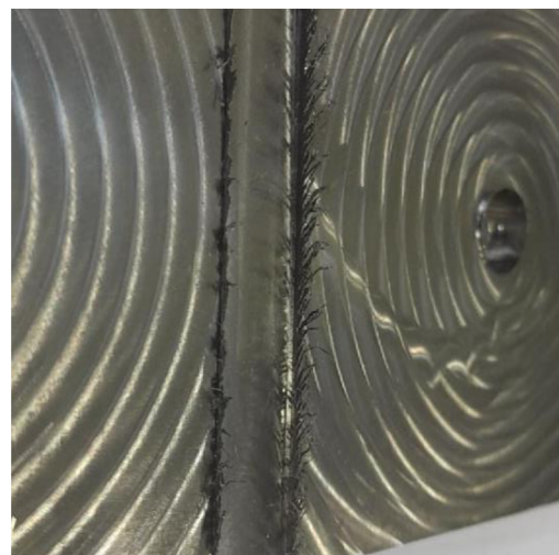
b) Drážka po průchodu opotřebeného nástroje
