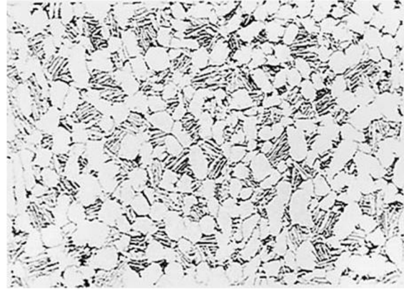
b) teplota žíhání 968 °C, ochlazení na vzduchu
