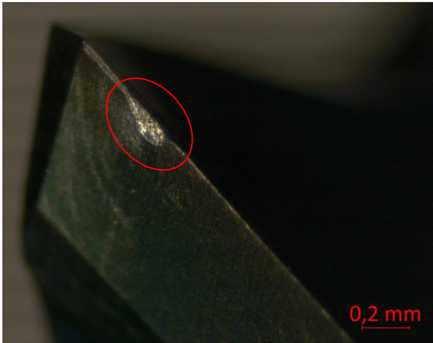
Obr. 54 Opotřebení na hřbetě u frézy GÜHRING.
