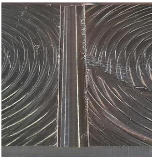
a) Drážka po průchodu neopotřebeného nástroje
