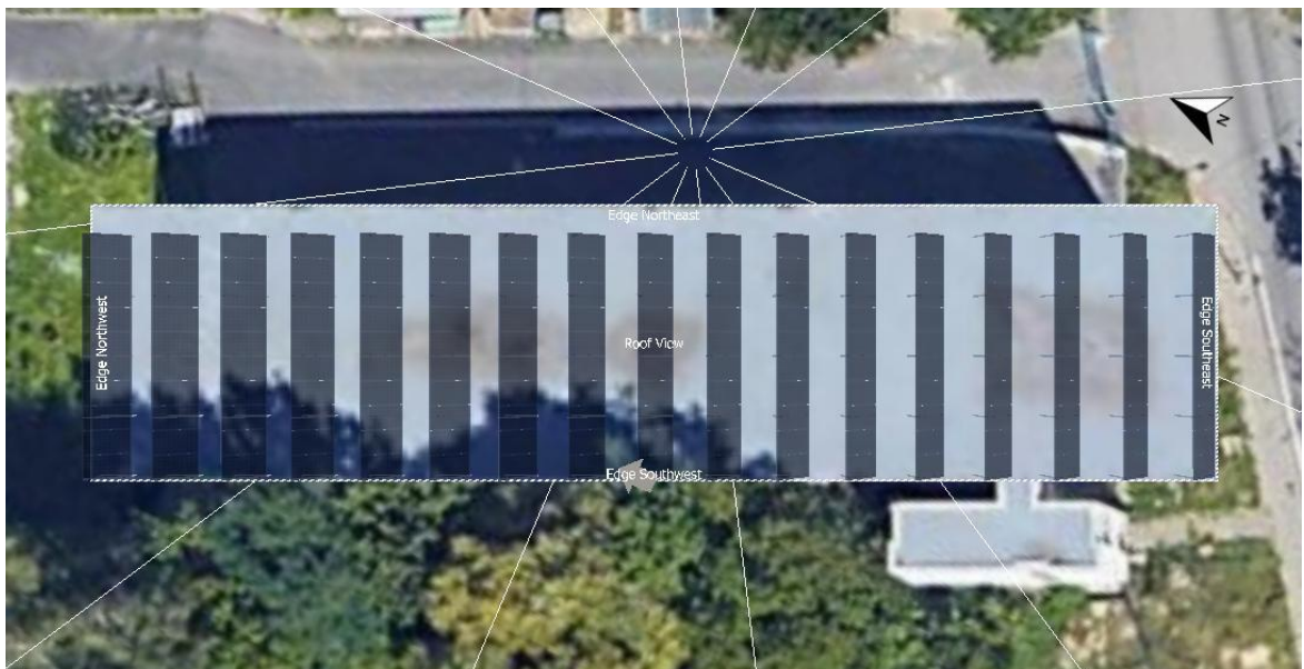
Obrázek 11-6 – rozmístění panelů na střeše budovy
