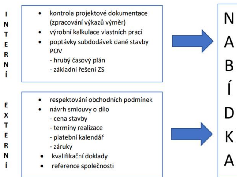
Obrázek 2 - Schéma nabídkové přípravy [zdroj [4]; zpracování vlastní]
