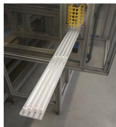
Obr. 35 Hotová základní část přípojnice.
