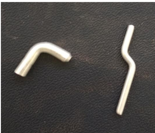
Obr. 34 L-kontakt a Z-kontakt.
