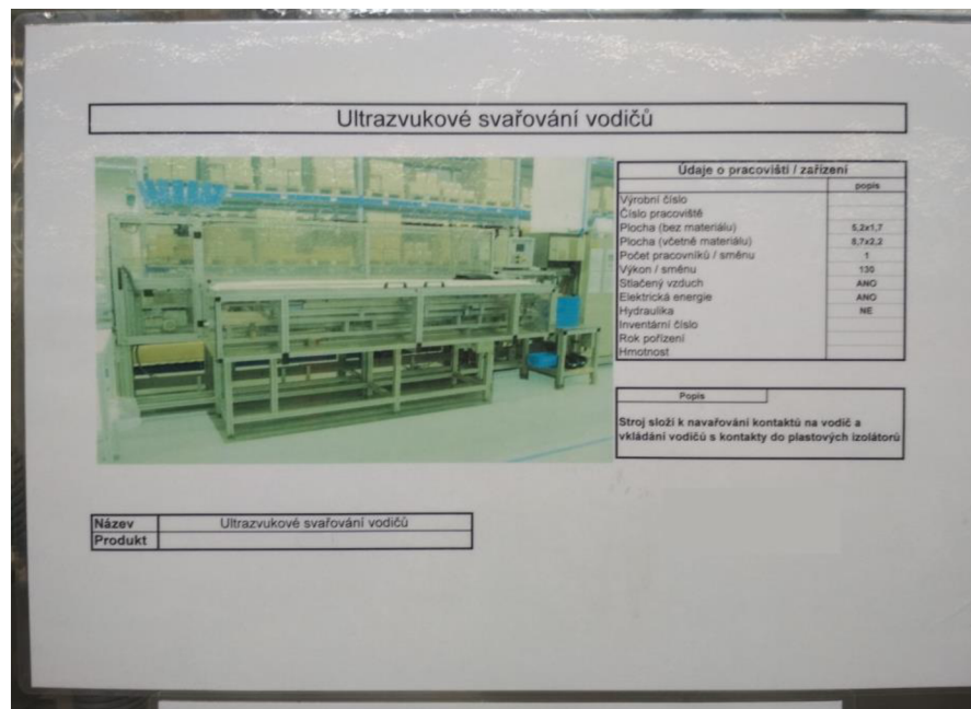
Obr. 31 Technické údaje o zařízení pro ultrazukové svařování vodičů.
