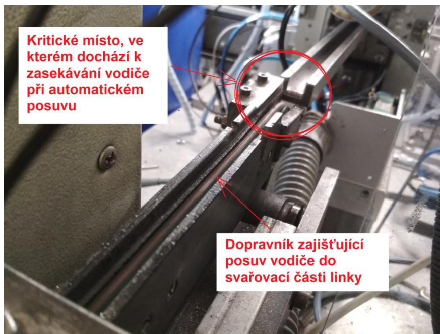
Obr. 56 Kritické místo přechodu z dopravníku do svařovací části.
