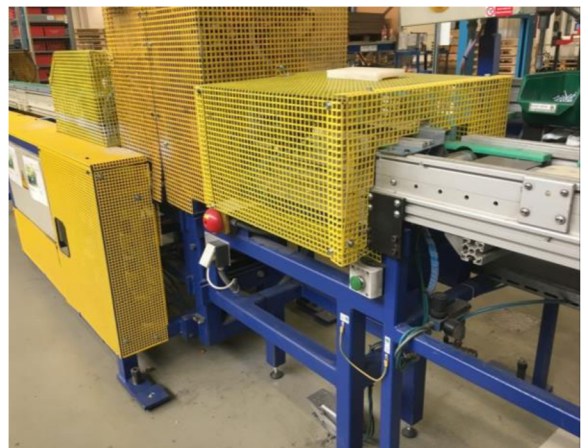
Obr. 39 Část linky pro zanýtování profilů.
