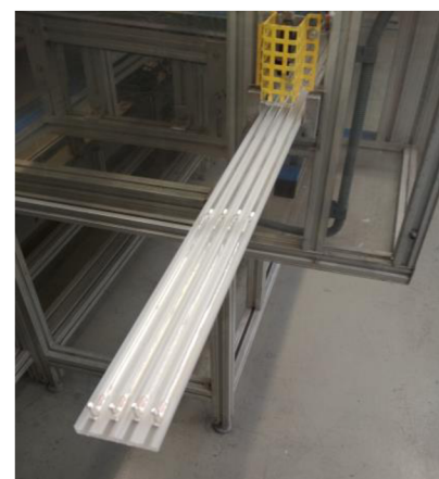
Obr. 35 Hotová základní část přípojnice.
