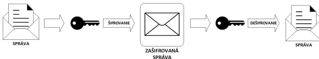
Obr. 1.1: Princíp šifrovania a dešifrovania správy v symetrickej kryptografii
