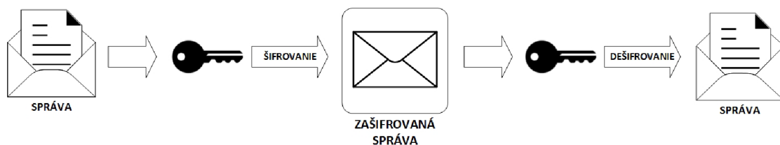
Obr. 1.1: Princíp šifrovania a dešifrovania správy v symetrickej kryptografii
