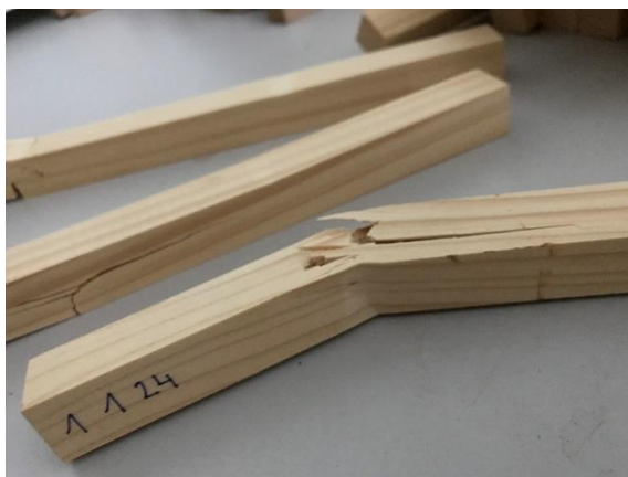
Obrázek 10 Zlomený vzorek po dokončení zkoušky (Zdroj: Vlastní)
