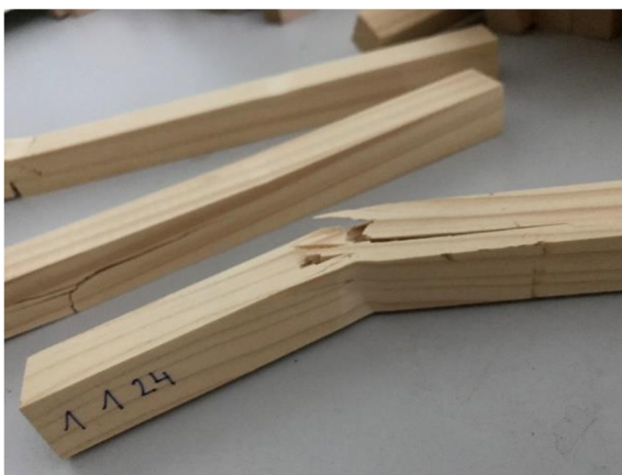
Obrázek 10 Zlomený vzorek po dokončení zkoušky (Zdroj: Vlastní)
