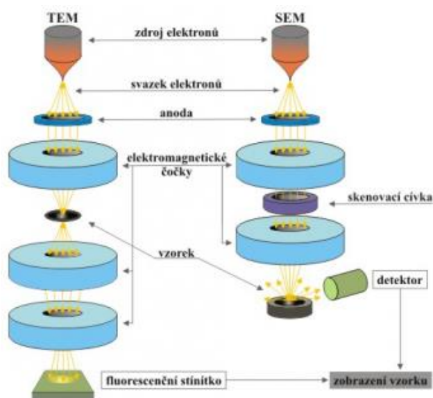
Obrázek 14 Schématické znázornění principu transmisního (vlevo) a řádkovacího (vpravo) elektronového mikroskopu. [Zdroj: http://www.fzu.cz/popularizace/electronovym-mikroskopem-do-nitra-materialu-aneb-jak-vypada-jejich-struktura ]
