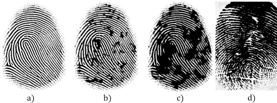
Obrázek 5.5: Příklady výstupů generátoru vlivu tuhého mýdla. Na obrázku a) je původní obrázek. Obrázky b) a c) zobrazují různé úrovně intenzity poškození. Obrázek d) zobrazuje reálný nasnímaný otisk.
