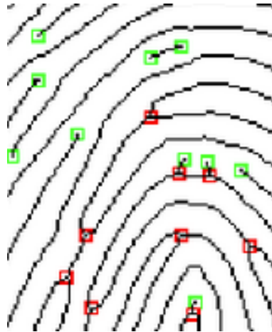
Obrázek 2.5: Detekce markantních bodů. Zeleně vyznačeno ukončení, červeně rozdvojení. Převzáno z [12].
