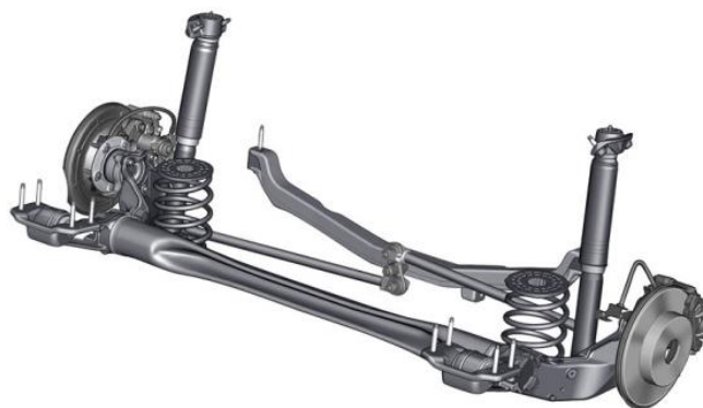
Obr. č. 3 – Wattův přímovod
