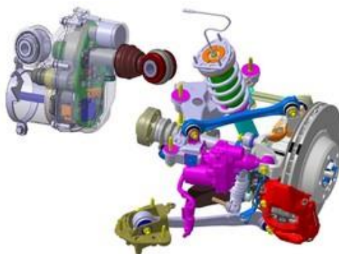
Obr. č. 13 – Konstrukce aktivního řízení zadních kol Zdroj: webový portál www.autoweek.cz , 2014
