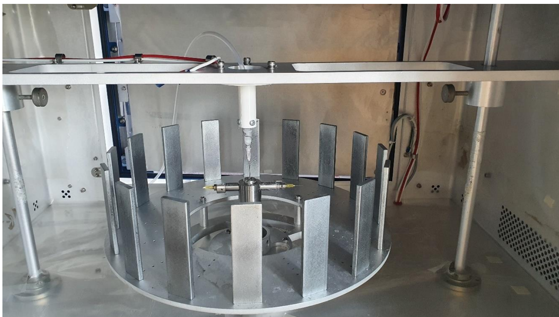
Obr. 11: Prístroj FibeRio CycloneL1000 s upraveným kontinuálnym dávkovaním
