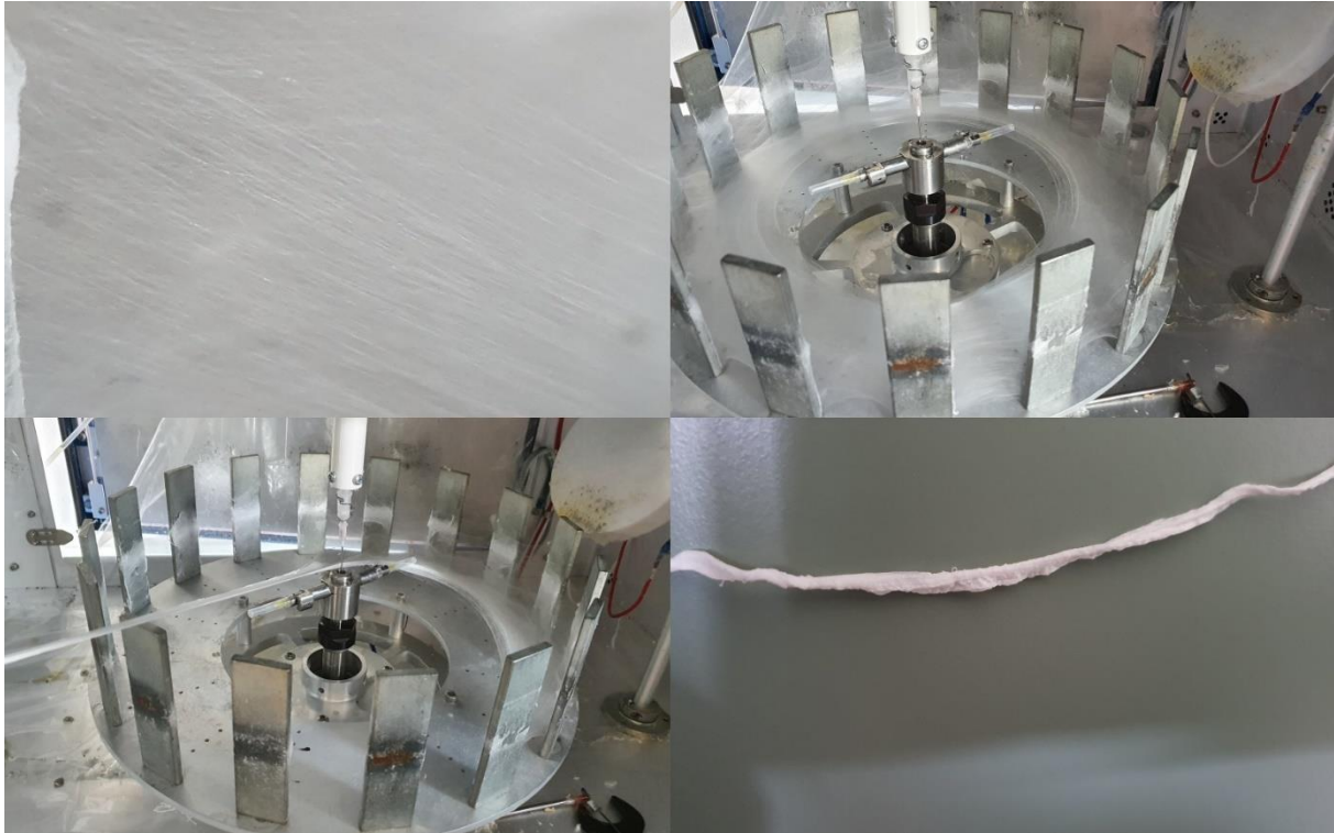
Obr. 20: Zvlákňovanie roztoku P3HB_FORM; horné fotky zobrazujú ideálne vlákna ihneď po zvláknení, spodné fotky zobrazujú proces zberu vlákien a získané vlákna
