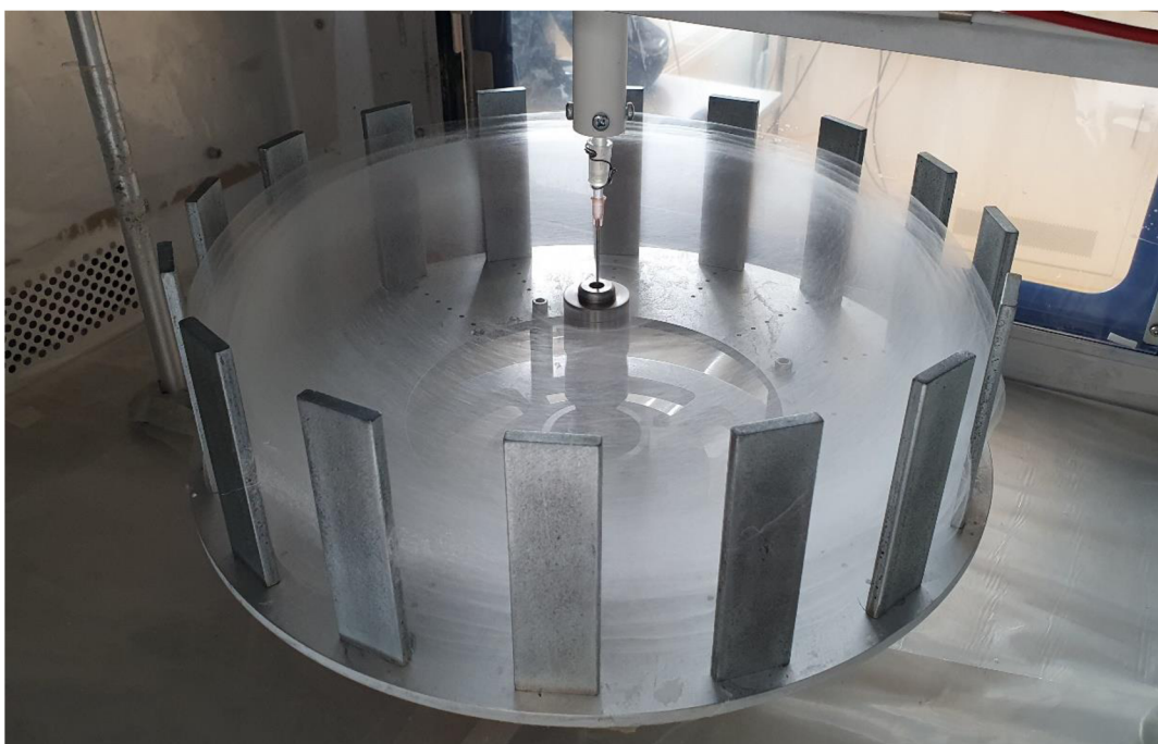
Obr. 17: Tvorba ideálneho „nadýchaného“ kokónu vlákien procesom odstredivého zvlákňovania
