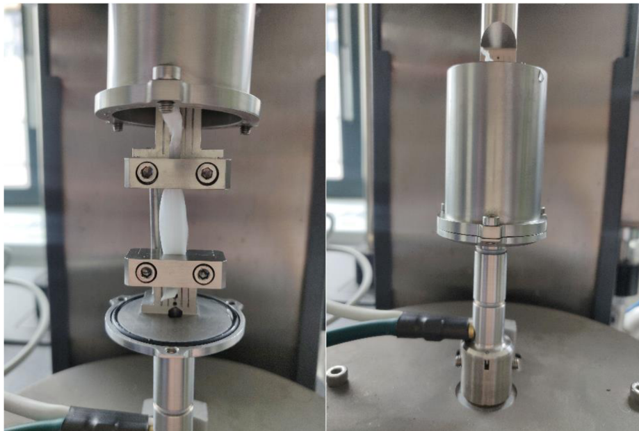
Obr. 14: Upnutie vzorky P3HB_VATA a uzatvorenie vzorky do nádoby s vodou
