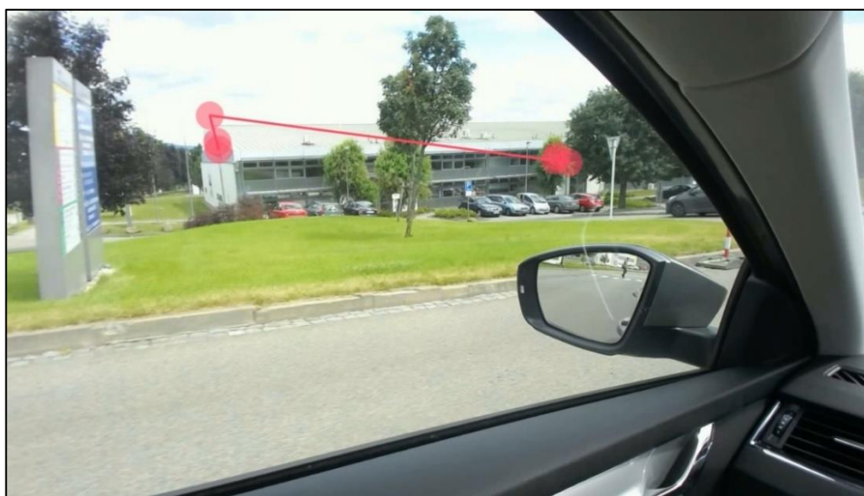
Obr. 29 : Řidič sleduje budovu firmy Control Techniques Brno s.r.o. po levé straně (3,12 s do projetí kolem figuranta vzdálenost 20 m do projetí kolem figuranta, rychloměr 45 km/h) (vlastní zdroj)
