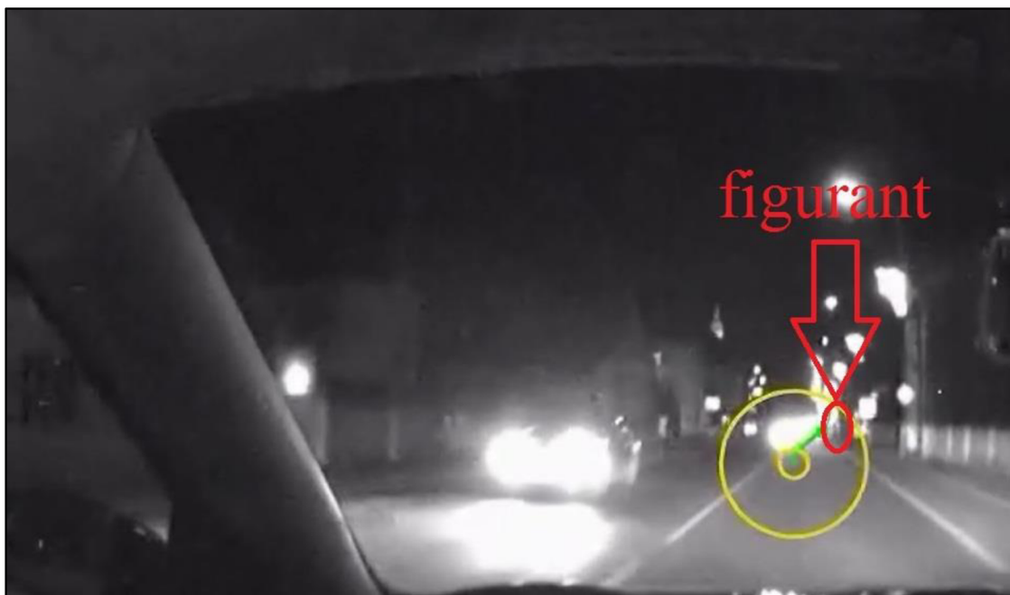
Obr. 41: Oslnění světlometry protijedoucího vozidla (čas 6,32 s do projetí kolem figuranta, vzdálenost 58,4 m do projetí kolem figuranta, rychlost 46 km/h)
