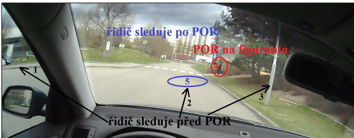
Obr. 28: Nestandardní jízdy – optické reakce řidiče na různé podněty před a po POR řidiče na figuranta, včetně POR řidiče na figuranta (vlastní zdroj)
