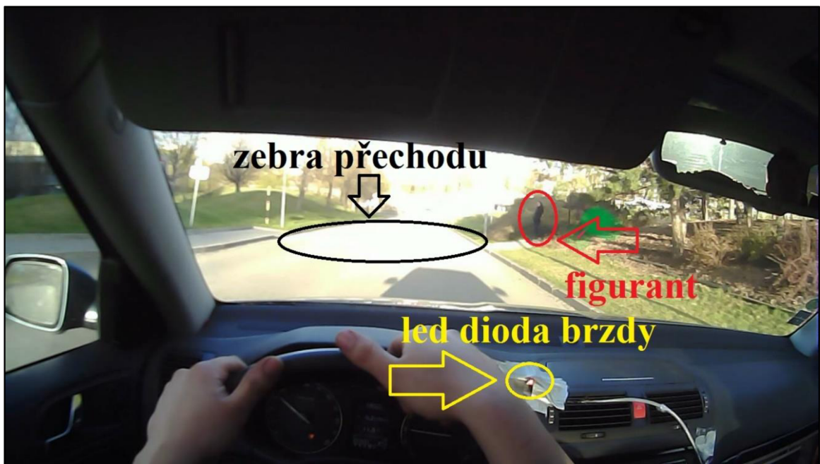
Obr. 31: Výhled řidiče z vozidla (čas 1,05 s do projetí kolem figuranta, vzdálenost 10 m do projetí kolem figuranta, rychlost 40 km/h) (vlastní zdroj)
