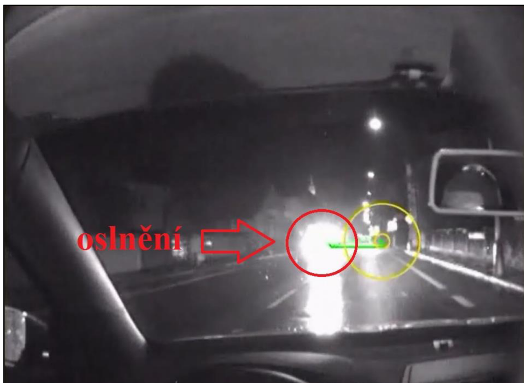
Obr. 39: Oslnění vyjíždějícím vozidlem z ulice J. Fučíka, která se nachází před sledovaným přechodem (čas 7,0 s do projetí kolem figuranta, 68,1 m do projetí kolem figuranta, rychlost 41 km/h)
