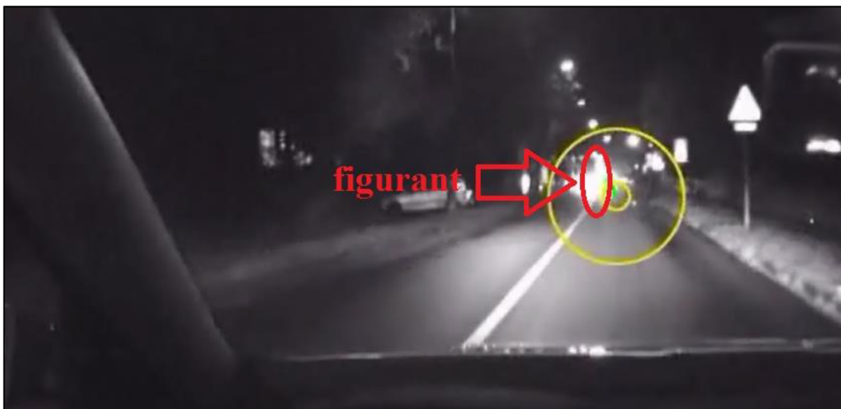
Obr. 36: Oslnění řidiče dálkovými světly – špatně viditelný figurant v levém jízdním pruhu vozovky (čas 3,5 s do projetí kolem figuranta, vzdálenost 40 m do projetí kolem figuranta, rychlost 45 km/h)
