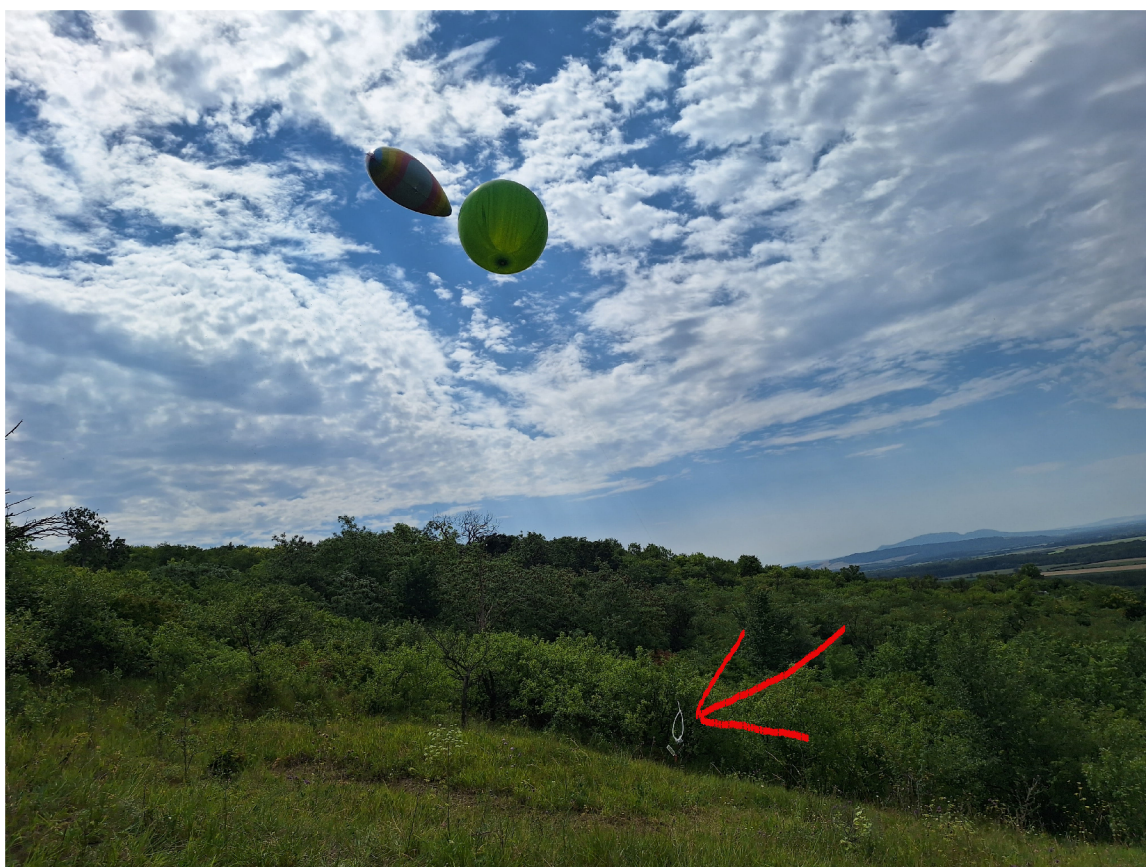
Obrázek 14.6: Zařízení PicoBaloonu přivázané k nosným balónkům při testu, kdy bylo zařízení uvázané k zemi přes kotvicí lanko.
