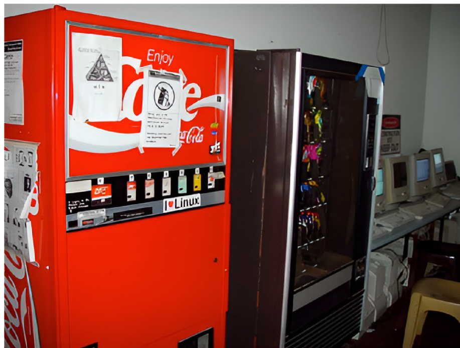
Obrázek 2.2: Upravený automat na Coca Colu z roku 1982, který je považovaný za první IoT zařízení. 7
