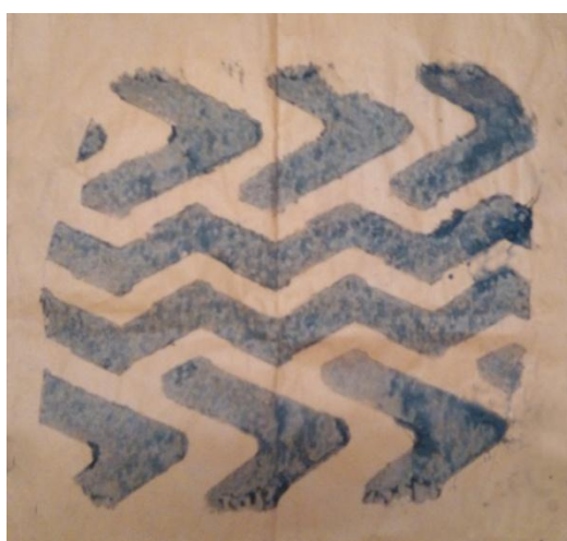
Obrázek 40: Ukázka otisku z rozmetadla Fliegl ASW 268 s pneumatikami Vredestein Flotation
