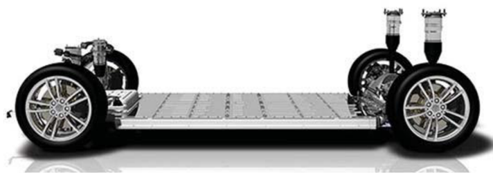
Obrázek 2: Tesla S – lithiová baterie
