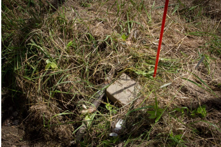
Obr. 3.1 Stabilizace železnou nohou a hlavou z plastu
