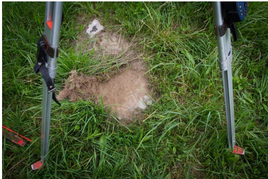
Obr. 3.2 Stabilizace vysekáním křížku
