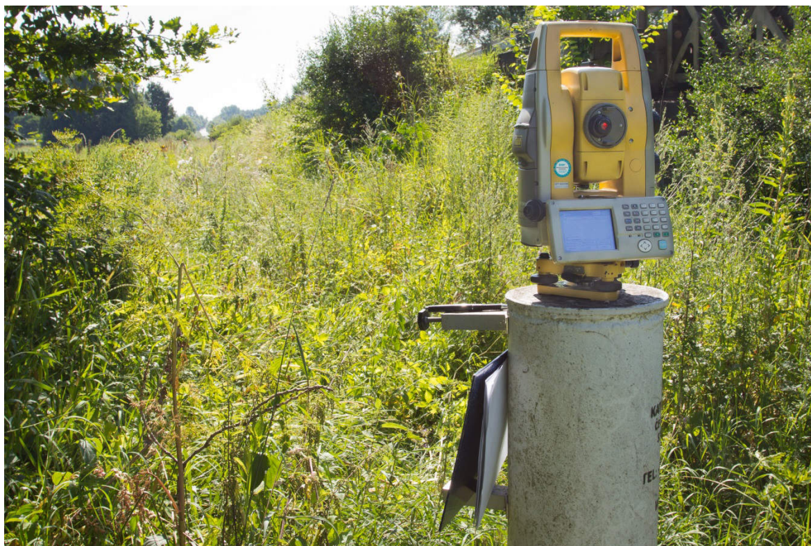
Obr. 6.2 Topcon GPT-9003M na kalibrační základně Bukovina
