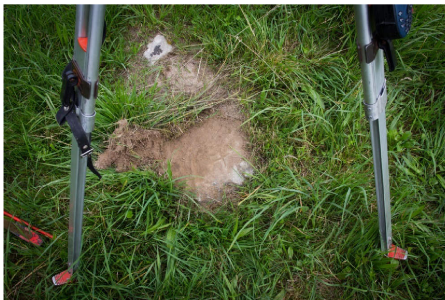
Obr. 3.2 Stabilizace vysekáním křížku
