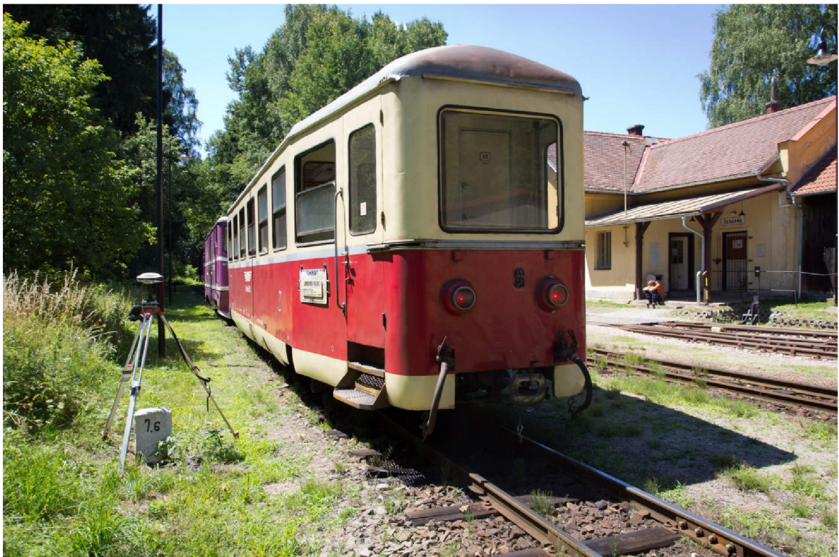
Obr. 2.3 Bod PPBP stabilizován v kilometrovníku na zastávce Lovětín
