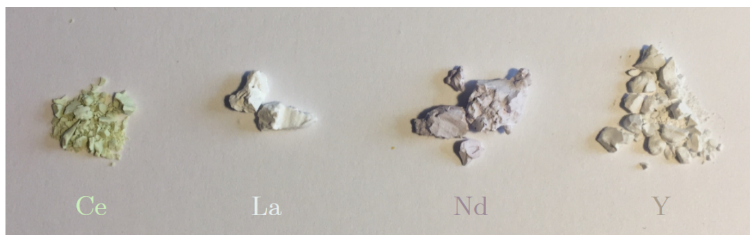
Obrázek 5.2: Dopované částice ZnO v poměru 1 : 4. Zleva dopanty Ce, La, Nd a Y.
