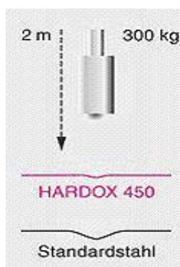
Obr. 5.2 Rázová zkouška oceli Hardox 450 [9].
