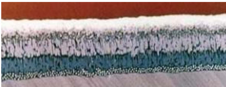
Obr. 4.3 Příčný řez povlakem žárového zinku [12].
