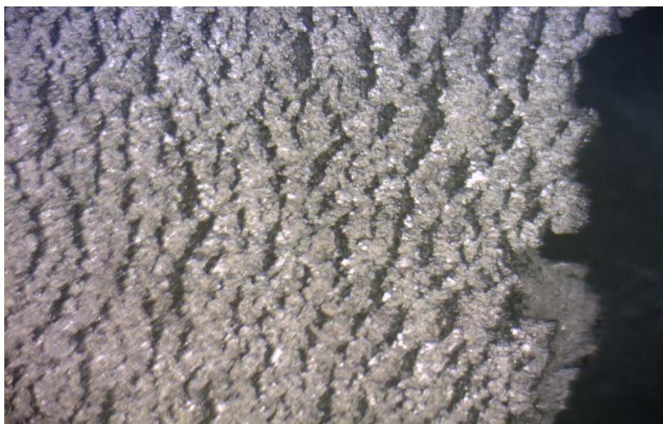
Obr. 5.15 Vzniklé trhliny po tahové zkoušce oceli Weldox 500.
