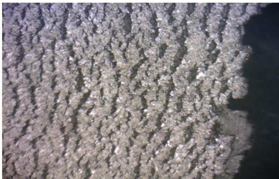
Obr. 5.15 Vzniklé trhliny po tahové zkoušce oceli Weldox 500.
