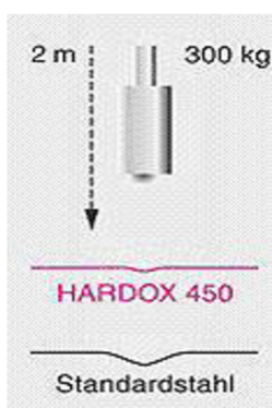
Obr. 5.2 Rázová zkouška oceli Hardox 450 [9].
