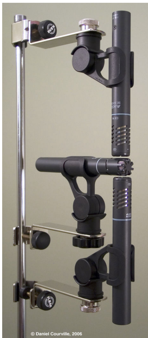
Obr. 5.2: Konfigurace se třemi mikrofony pro záznam B format složek [6].
