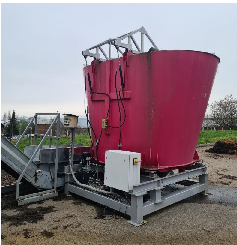
Obr. 14: Mixér sloužící k přípravě zakládky
